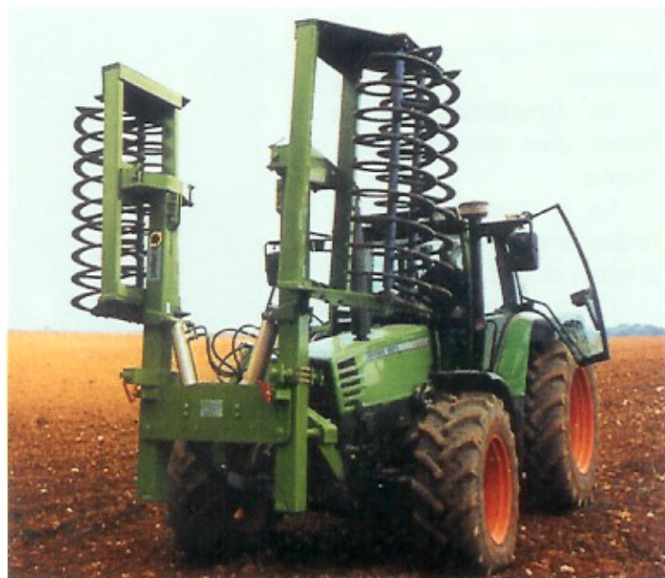
Photo à droite: Synchrolab 2x1,5 m replié, pour le transport sur route
